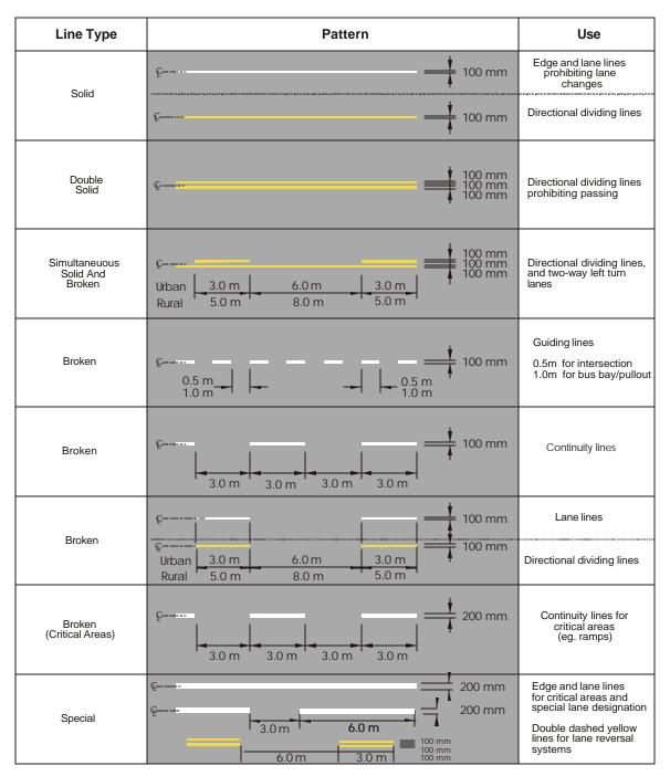
NOTE: ALL LONGITUDINAL LINES ARE TO BE REFLECTORIZED
